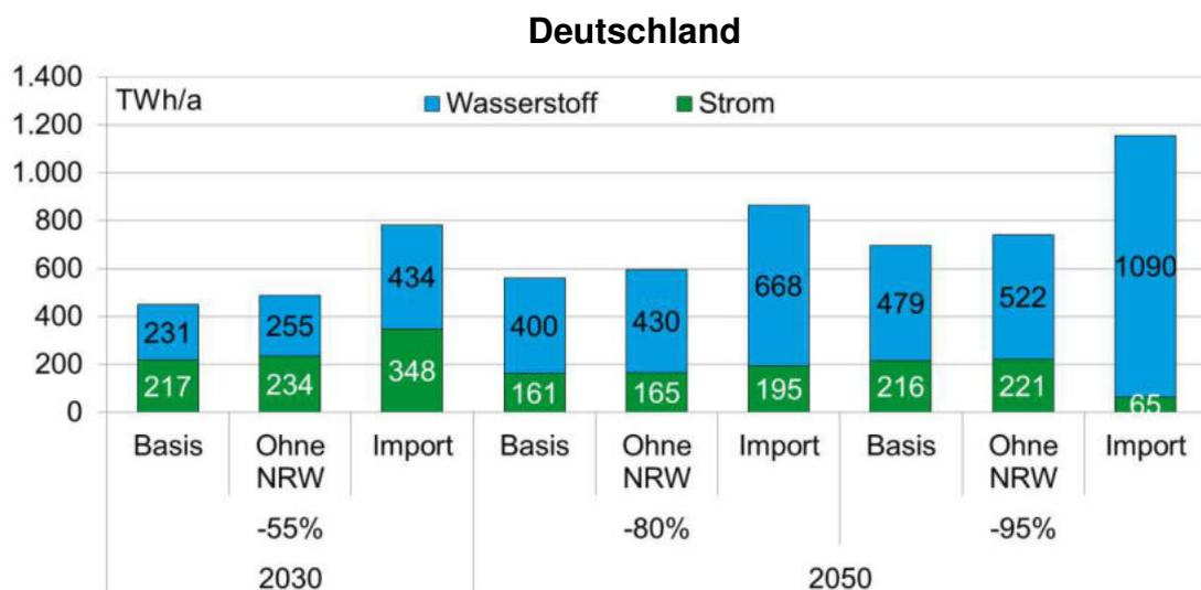
**Abbildung 45: Energieübertragung nach Energieträgern in Deutschland in Abhängigkeit von H<sub>2</sub>-Importen nach NRW und Deutschland in TWh/a**
